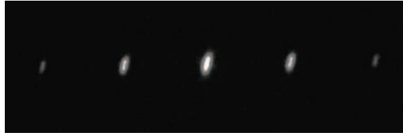
Obrázek 2.1: Příklad následku aplikace tištěné optické mřížky na paprsek laseru.
