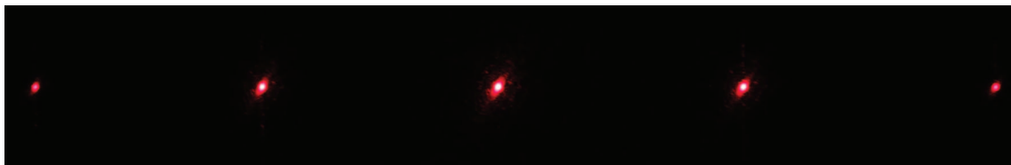
Obrázek 2.4: Výsledek difrakce nerozšířeného paprsku laseru na difrakční mřížce vytvořené na osvitovém zařízení.
