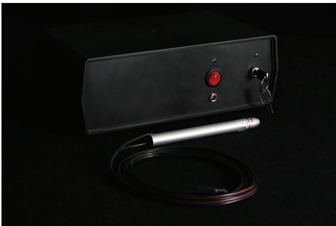
Obrázek D.5: Konečná forma uzamykatelného zdroje pro zdroj laserového záření.
