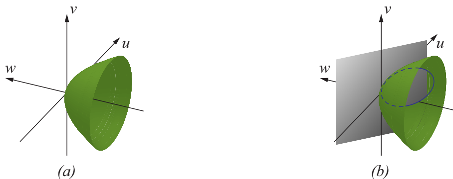
Obrázek 2.4: Rotační paraboloid. (a) Komponenty identické s optickým polem objektu (b) průsečnice rotačního paraboloidu a řezné roviny Fourierova spektra. [SIY04]
